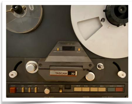
La cinta magnética poseía una velocidad de grabación superior a la que la reproductora Tascam tiene por lo que una vez digitalizada la cinta se modificó la velocidad de reproducción, adecuando al 50% la misma, controlando la frecuencia correspondiente.
